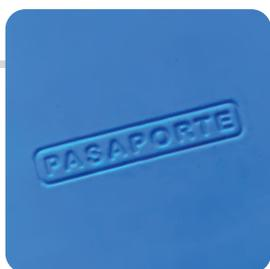
**Termograbado "golpe en seco" o relieve:** técnica que marca por calor y presión o por alta frecuencia, según el material utilizado, para conseguir un relieve.
