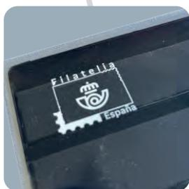
Marcaje **termograbado:** técnica de marcaje que mediante calor y presión transfiere una película sobre la superficie a marcar. Disponible en una amplísima variedad de colores, es especialmente indicado para marcar en oro y plata consiguiendo un brillo metálico.
